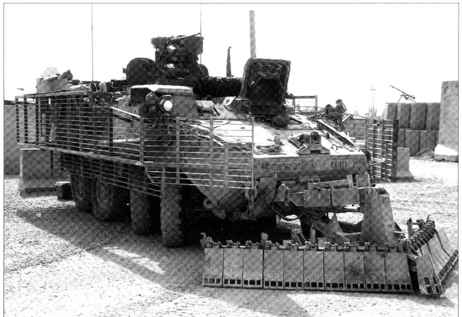
M1132 du génie, équipé de plusieurs dispositifs anti-mines.
