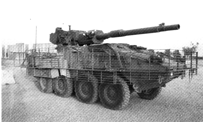
M1128 MGS, armé d'un canon de 105 mm. Il est protégé par des grilles anti-RPG.
