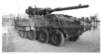
M1228 MGS, armé d'un canon de 105 mm. Il est protégé par des grilles anti-RPG.
