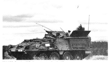
M1129 Stryker MC tirant au mortier de 12 cm.
