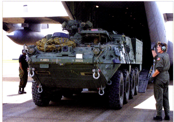
Stryker M1129 déchargé d'un C-130. La place disponible ne permet pas l'emport à la fois du véhicule, du matériel et de la troupe.
