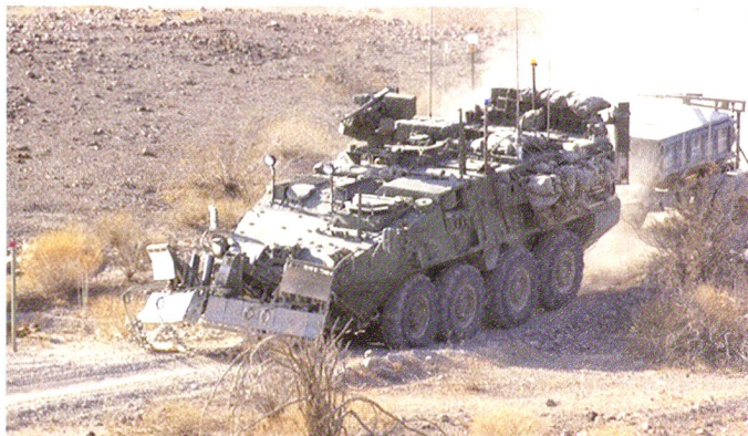
Ci-dessus : M1131 du 18th Engineer Company, 3 rd Brigade, 2 nd Infantry Division en Irak. L'engin peut être équipé de lames et de rouleaux anti-mines, ainsi que du système explosif MICLIC.
