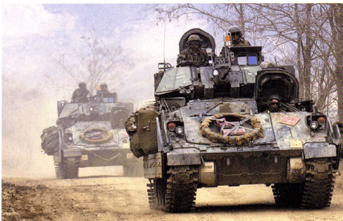
M3A2 Bradley du 2-9 Cavalry. L'engin de 40 tonnes embarque un équipage de trois ainsi que deux soldats embarqués. La place restante est prise par du matériel et de la munition supplémentaire.
