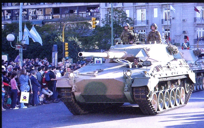
Le TAM argentin, sur châssis de Marder allemand.
