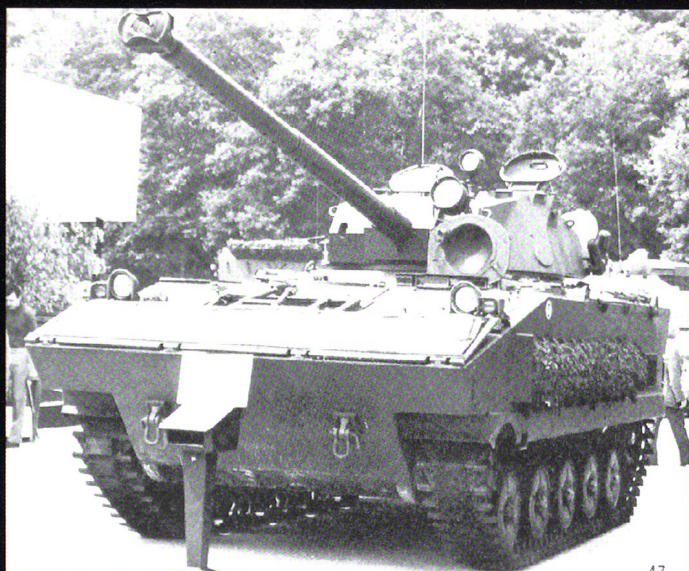
L'AMX10P a également reçu la tourelle TS90, mais n'a pas été introduit sous cette forme.
