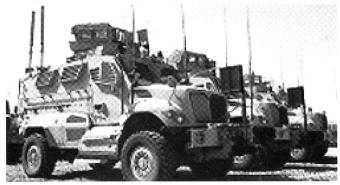
L'US Army Research Laboratory a contribué au développement du Mine-Resistant Ambush-Protected (MRAP). Il est conçu en matériaux compositesplus légers que l'acier. Des composantes de ce système ont été installées par la suite sur d'autres engins.
