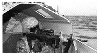
Développé par l'US Army Armament Research, Development and Engineering Center, la protection balistique est un système construit en verre et en acier, fixé sur le toit des véhicules blindés. Il s'est révélé nécessaire dans les engagements en zones urbaines, plusieurs équipages ayant été attaqué à la grenade, mais également avec des pierres, des armes incendiaires ou des liquides irritants, parfois même des acides.
