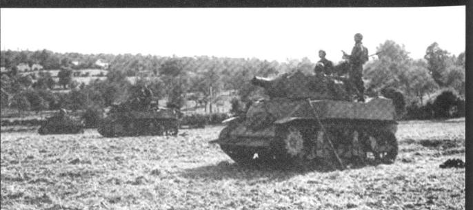
75 mm Gun Motor Carriage M8, sur châssis du M3. Celui-ci appartient au 113<sup>th</sup> Cavalry Regiment à Heure le Renan, 9 septembre 1944.
