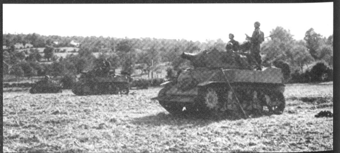
75 mm Gun Motor Carriage M8, sur châssis du M3. Celui-ci appartient au 113 th Cavalry Regiment à Heure le Renan, 9 septembre 1944.
