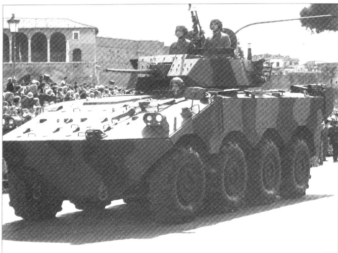
Le véhicule blindé VBM Freccia 8x8 transport de troupes est réalisé sur la base du Centauro . 249 ont été produits pour l'armée italienne, équipée d'une tourelle Hitfist Plus , armée d'un canon Oerlikon KBA de 25 mm identique à celle du Dardo chenillé.
