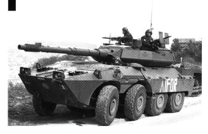
Le char léger à roues *Centauro* de 25 t, armé d'un canon de 105 mm, est une réussite technique de l'industrie italienne. 400 ont été réalisés pour l'armée italienne et 84 pour l'armée espagnole. Une version armée d'un canon de 120 mm est à l'étude.
