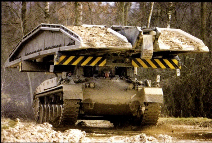
Le char poseur de ponts est conçu à partir du châssis du char 68. Il peut poser un pont de 18 mètres.
