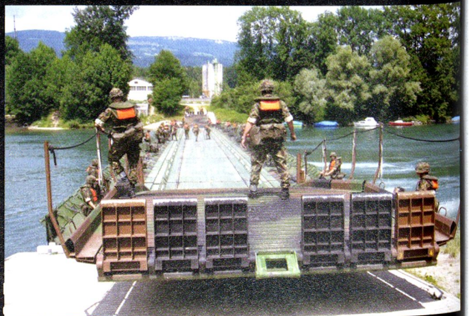
Le pont flottant 95 (PFM) peut atteindre 120 mètres. Il peut également être engagé sous forme de barges.
