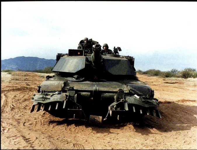
A l'engagement, un char par section est équipé d'une charrue anti-mines (Clearing Blade System); ces 4 véhicules sont parfois regroupés en une seule section.
