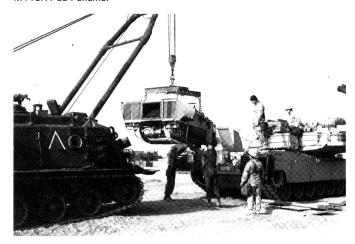
M88A1 remplaçant un Powerpack sur un M1A1 de l'USMC.
