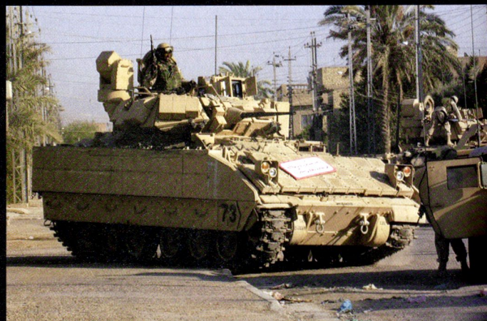
Le M2A3 dispose d'une optronique et d'une conduite de tir jour/nuit stabilisées à l'arrière de la tourelle.
