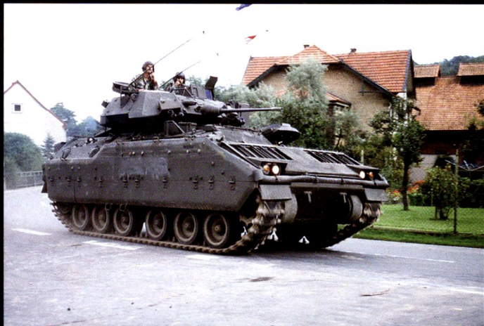
Le M2 d'origine (500 PS) emmène un équipage de 3 ainsi que 6 fantassins, sur des sièges individuels.
