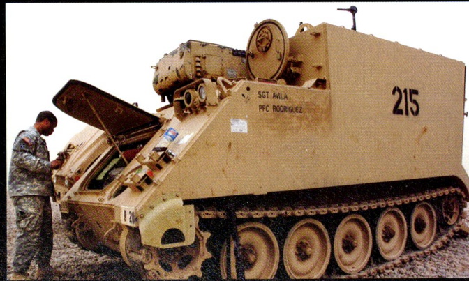
M577A1 de commandement, au compartiment arrière surélevé.
