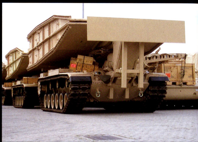
L'AVLB porte un pont ciseaux de 19 mètres.
