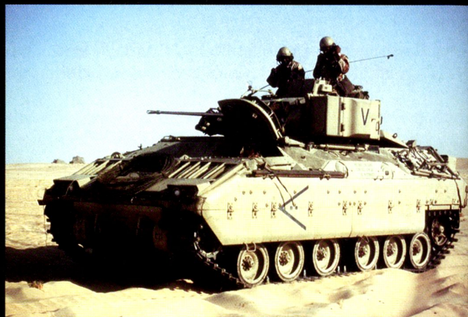
Chaque fantassin est en mesure d'engager son arme à partir de meurtrières blindées, tirant vers l'arrière ou sur les côtés.
