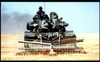
Le M728A1 est un M60 destiné au Génie, équipé d'une lame anti-mines et d'un canon de 165 mm.
