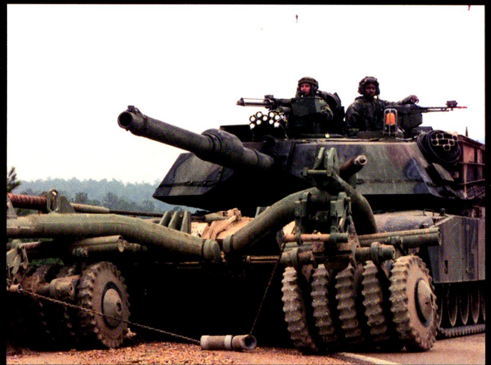
Un rouleau anti-mines (Clearing Roller System) peut également être monté à l'avant de l'Abrams.
