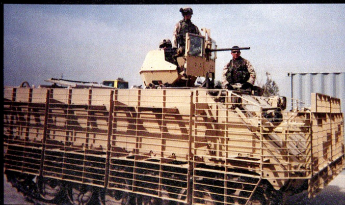
Le Supergavin est une version surblindée du M113A3
