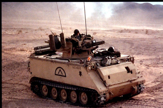
Le M163 Vulcan est une version DCA équipée d'un canon M61 de 20 mm.
