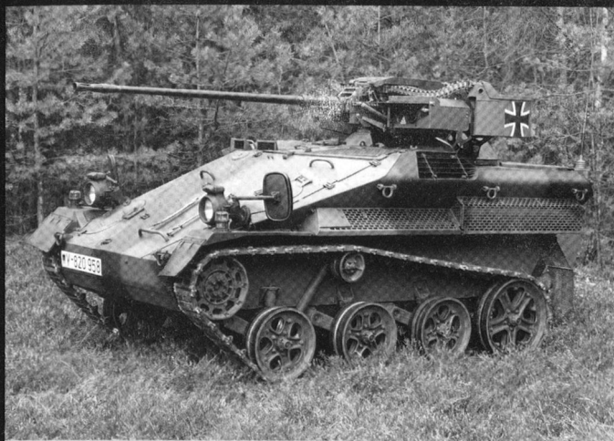
Le Wiesel, ici armé d'un canon de 20 mm, sert dans les unités parachutistes allemandes.
