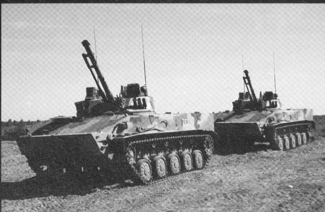
BMD-4 armé d'un canon de 100 mm et de 30 mm.
