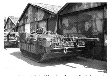
ll est remplacé par le Strdw-103 ou char « S » au profile très bas, armé d'un canon de 105 mm à chargement automatique.
