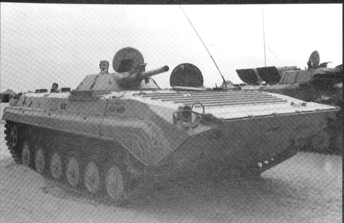
Le BMP-1 d'origine est armé d'un canon à basse pression de 73 mm.
