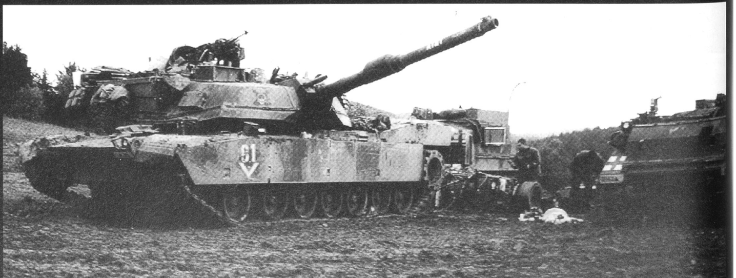
Un M1A1 subit des réparations en campagne. On aperçoit le moteur et la boîte de vitesse (Powerpack) déposés derrière l'engin.
