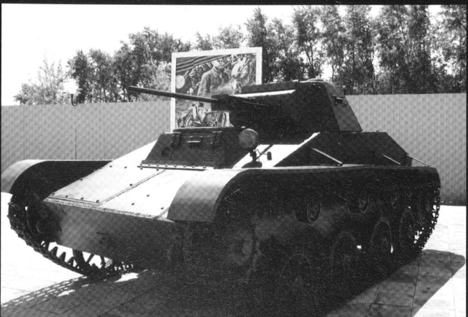
Le T-60 est un char de reconnaissance soviétique, armé d'un canon de 20 mm.
