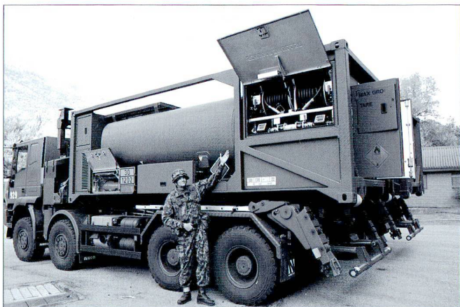
La nouvelle BBC avec ses 4 pistolets à carburant (2 de chaque côté). Ici le container se trouve encore sur l'Iveco 8X8. A l'arrière, on trouve les pompes et le compteur principal.
