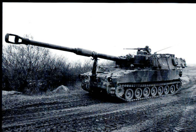
Son canon de 15,5 cm et 47 calibres porte à 27 km de distance.
