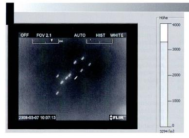
Image infra-rouge d'un sac tracté; on remarque les traces lumineuses des coups de 35 mm. Toutes les les illustrations © Forces aériennes
