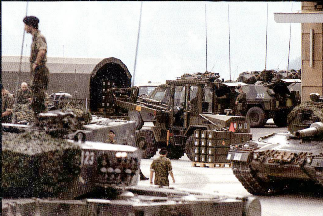
Le FUG permet le déchargement de palettes et de nombreux travaux sur le terrain, par exemple le ravitaillement de munition.
