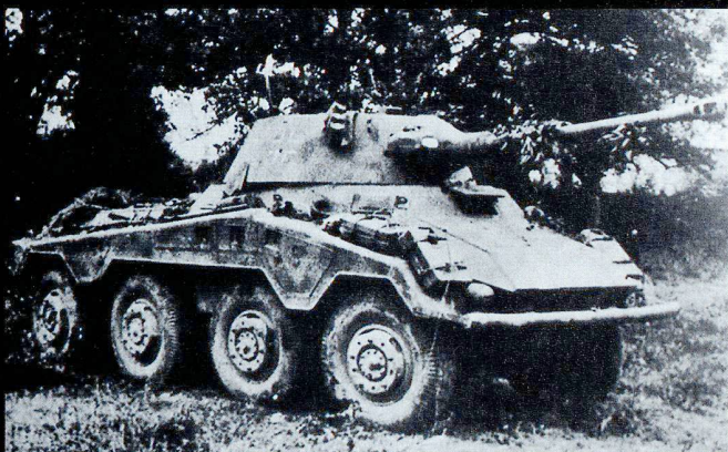
Le Sdkfz 234 8x8 donne plusieurs versions équipées de canons de 50 ou de 75 mm. Ici, le Puma , construit à quelques dizaines d'exemplaires.
