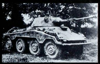
Le Sdkfz 234 8x8 donne plusieurs versions équipées de canons de 50 ou de 75 mm. lci, le *Puma*, construit à quelques dizaines d'exemplaires.
