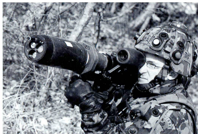
Les véhicules et les armes sont équipés d'émetteurs et de réflecteurs afin d'enregistrer l'effet des combats.
