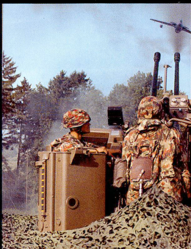
Le canon bitube 35 mm a une cadence de 1'100 coups par minute ; sa portée est de 4 km contre des buts aériens. Toutes les photos © Forces aériennes.
