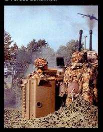
Le canon DCA 63 d'origine nécessitait une équipe de pièce importante pour la mise en batterie ainsi que pour le rechargement des pièces.
