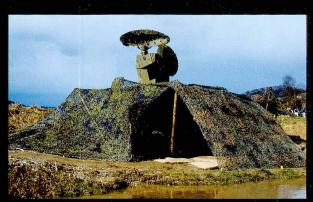
L'appareil de conduite de tir comprend un radar de surveillance, un radar de poursuite, ainsi qu'un viseur optique jour/nuit.
