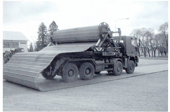
Mise en place de routes rapides, déroulées depuis un camion. Ces systèmes permettent de faciliter l'accès et le départ des franchissements. Photo © Auteur.
