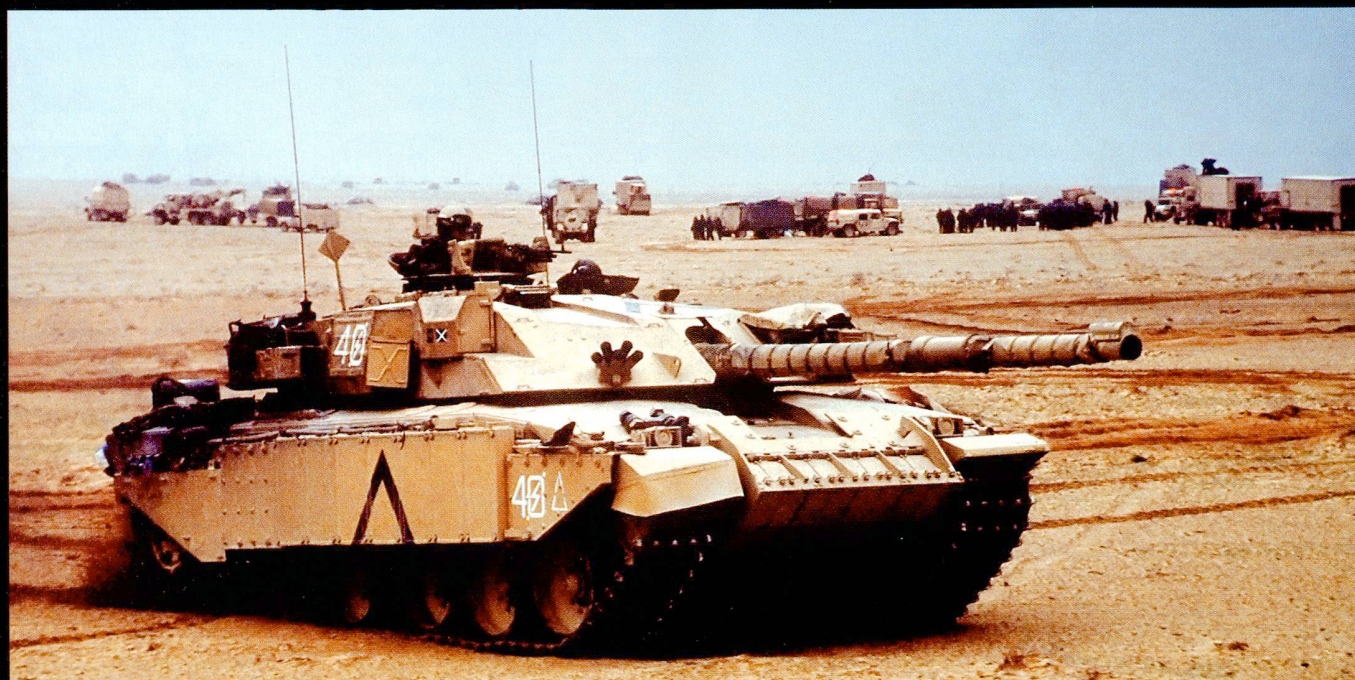
Le groupe motopropulseur Rolls-Royce/Perkins Condor de 1'200 PS du Challenger 1 a causé de nombreux soucis, en particulier dans le désert.
