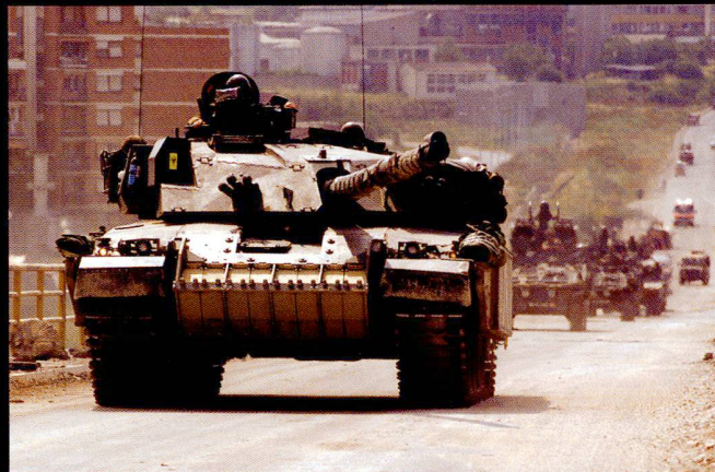
Les Challenger 1 déployés dans le Golfe et dans les Balkans ont reçu des surblindages latéraux à partir de 1992.
