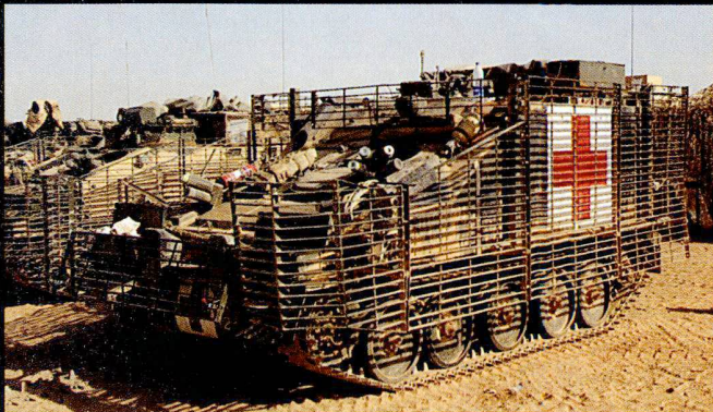
Un Samaritan en Irak, revêtu d'un grillage anti-RPG.
