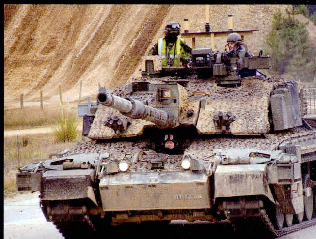
On distingue sur cette vue les fixations du blindage modulaire additionnel.
