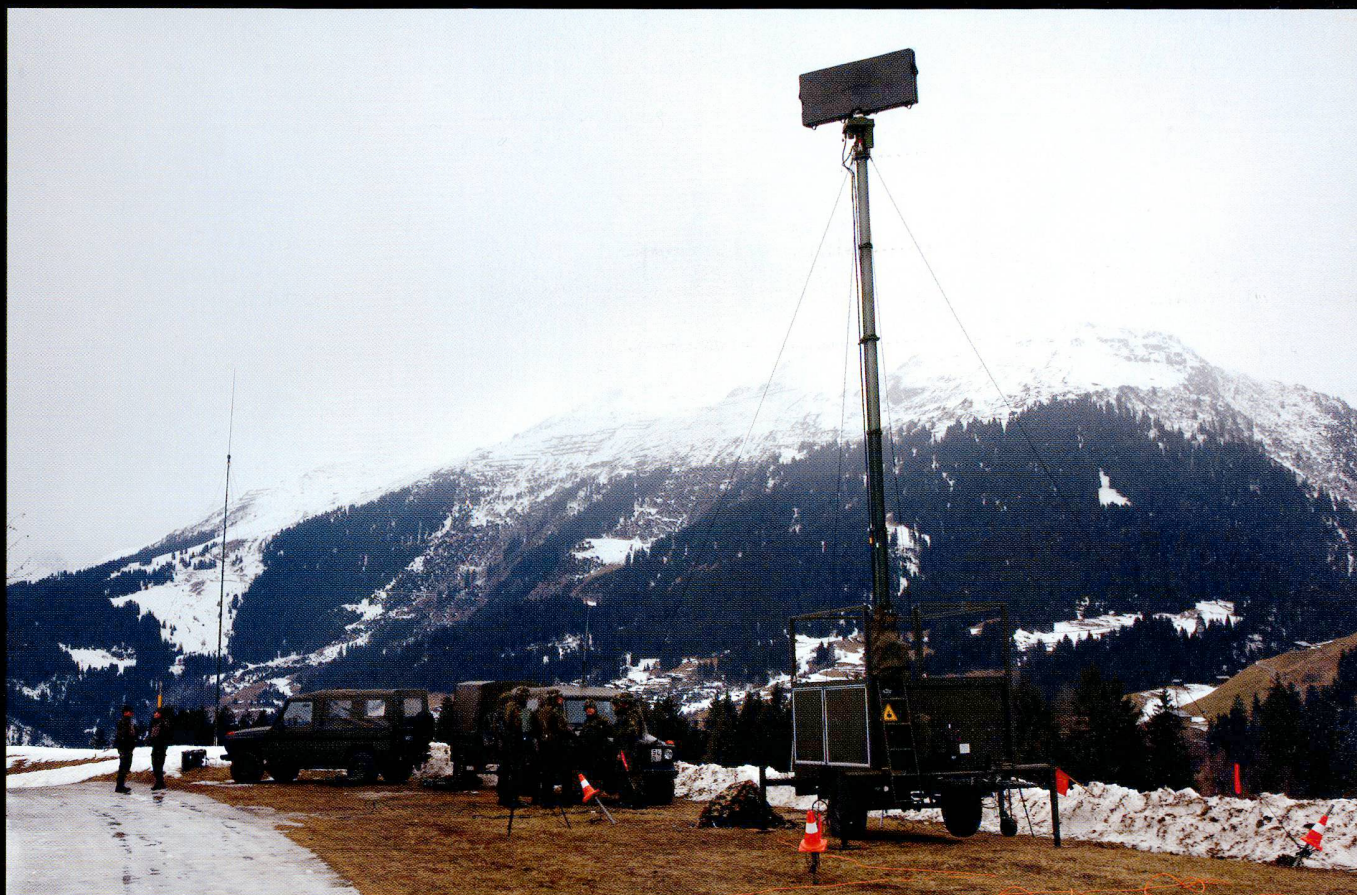
Le système radar Alert est un multiplicateur de forces pour l'engagement du système d'engin guidé léger DCA Stinger . En permettant la veille quelles que soient les conditions de visibilité et météorologiques, il permet un engagement optimal et à temps des unités de feu.
