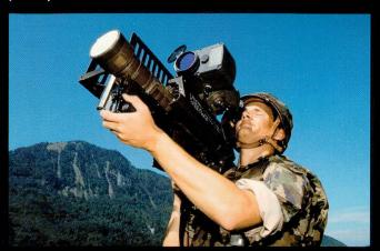
Le *Stinger* helvétique dispose d'un identificateur ami-ennemi (IFF) et peut être équipé d'un dispositif de visée jour/nuit.
