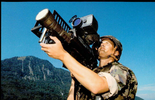
Le Stinger helvétique dispose d'un identificateur ami-ennemi (IFF) et peut être équipé d'un dispositif de visée jour/nuit.
