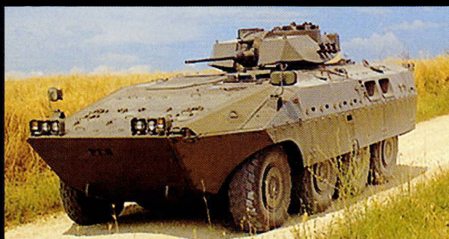
Le châssis 8x8 du Centauro est également la base d'une famille de véhicules de transport d'infanterie et d'exploration à roues.
