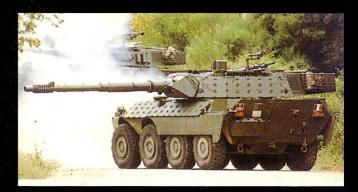
L'armée italienne, au sein de l'OTAN, dispose de réelle compétence dans la mise à disposition de forces légères, à l'instar du char léger à roues *Centauro* équipé d'une tourelle de 10,5 cm.
