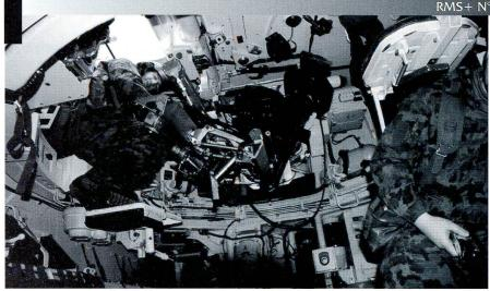
Compartiment de combat de l'obusier blindé M-109. Le chargement des munitions de 15,5 cm est assisté par un système hydraulique.
