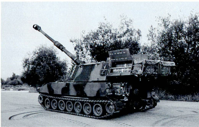
Les charges propulsives sont stockées à l'arrière de la tourelle du M-109.
