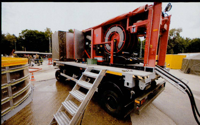
Le WELAB 6 sert au transport d'eau. Une pompe permet d'emmagasiner l'eau dans des bassins, afin de constituer des réserves.
