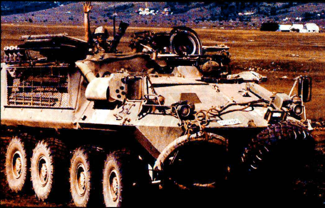
Le Bison est un Piranha de 2e génération (LAV II). Celui-ci porte un mortier de 81 mm.
