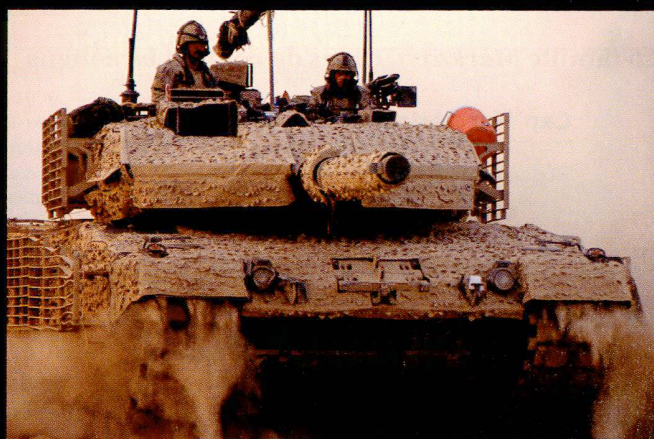
Ce Léo 2 est revêtu d'un camouflage multispectral Barracuda.
