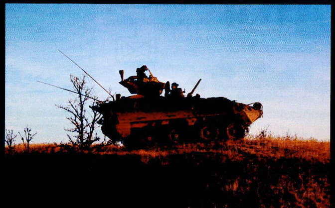
Les sections de reconnaissance possèdent également des Coyote armés de tourelles antichars TOW. On remarque à l'arrière l'avertisseur laser.
