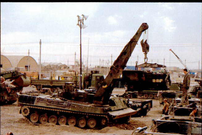
La maintenance est effectuée à ciel ouvert, grâce aux chars de dépannage Taurus. On reconnaît un Badger à gauche de l'image.
