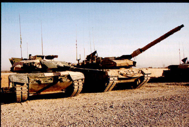
Comparaison côte à côte du Léopard 1 (C2) 42,4 tonnes et du Léopard 2A6M de 65 tonnes.
