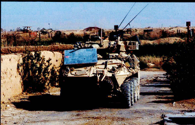
Actuellement, le Coyote 8x8 équipé d'une tourelle de 25 mm sert avant tout dans les formations de reconnaissance.
