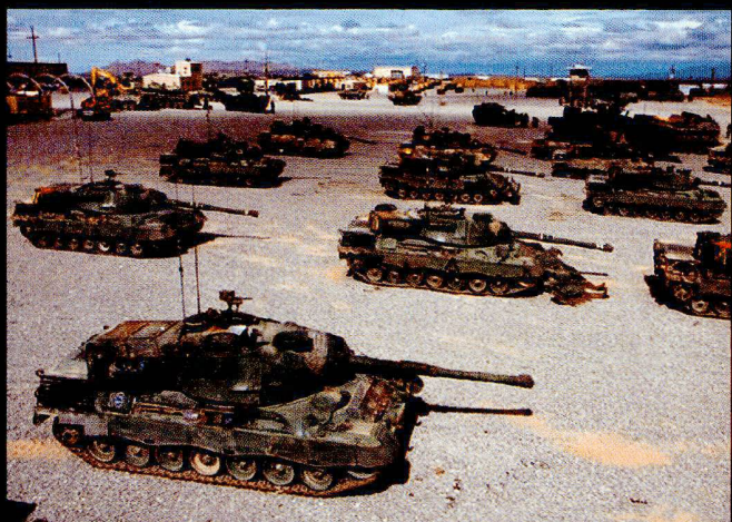
Un escadron complet et prêt au combat. Au centre, un char équipé d'une charrue de déminage et derrière, un engin équipé d'une lame.
