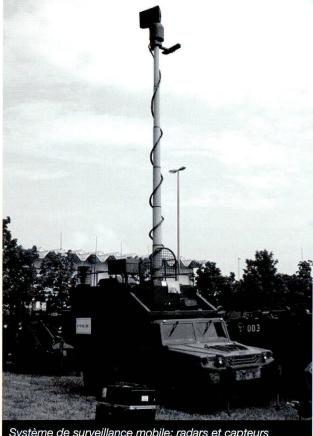
Système de surveillance mobile: radars et capteurs optiques
