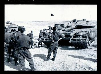
Ci-dessus et ci-dessous: Le *Merkava* 4 dispose d'un blindage amovible plus lisse que ses prédecesseurs. Le viseur principal est placé au-dessus de la tourelle. Mais l'essentiel des améliorations techniques est invisible pour les yeux... électronique, capteurs, contre-mesures électroniques. Au moins un char par compagnie dispose d'un système de déminage ou d'une lame de bulldozer.
