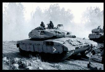
Ci-dessus et à gauche: Le *Merkava* 3 se reconnaît à ses blindages latéraux renforcés et inclinés. Le bouclier de tourelle est «percé» par le dispositif de visée du pointeur.
