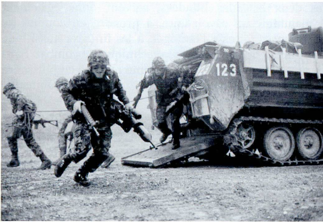
En 1989, le char de grenadiers 63/73 reçoit un nouveau blindage et un nouveau moteur ; son intérieur est réaménagé. Mais ses performances sont nettement inférieures au Léopard qu'il est sensé protéger, voire parfois... précéder.
