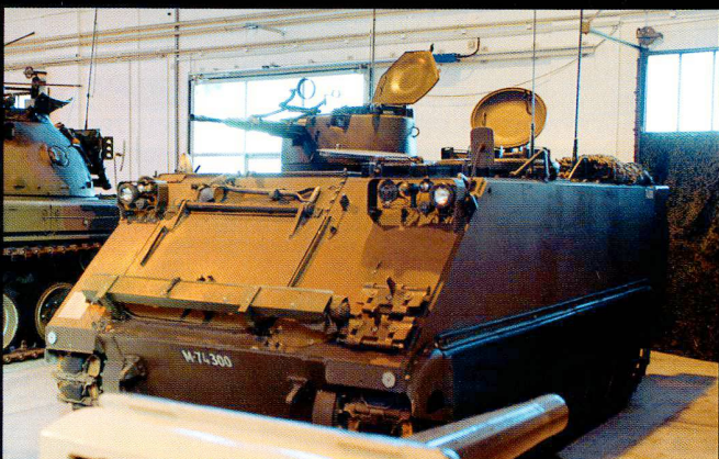
Le char de grenadiers 63/73 reçoit une tourelle de 20 mm Hispano capable de tirer contre des buts terrestres et aériens.
