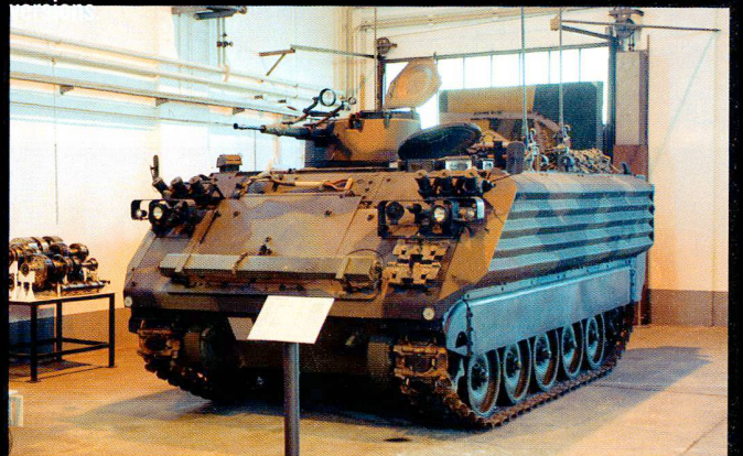
Le char de grenadiers 63/89 reçoit des réservoirs extérieurs, un nouveau moteur et un blindage espacé. Son intérieur est réaménagé.
