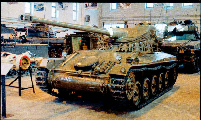
200 chars légers 51 (AMX-13) rapides et dotés d'un canon à chargement automatique sont achetés en France.
