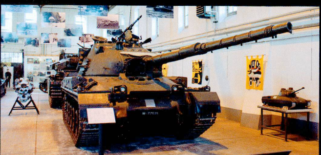
150 chars 61 sont développés et construits en Suisse - à l'origine armés d'un canon de 9 puis de 10,5 cm ainsi que d'un canon de 20 mm coaxial.
