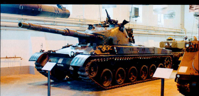
Plusieurs séries de chars 68 sont réalisées, avec un canon de 10,5 cm stabilisé. Ils utilisent une conduite de tir française et un moteur allemand, secondé par un agrégat ( Himo ) au bruit caractéristique...
