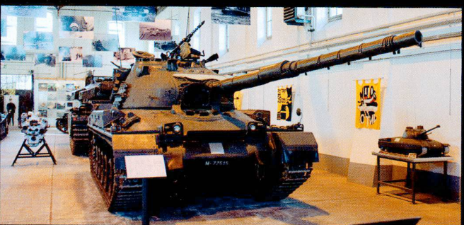
150 chars 61 sont développés et construits en Suisse - à l'origine armés d'un canon de 9 puis de 10,5 cm ainsi que d'un canon de 20 mm coaxial.
