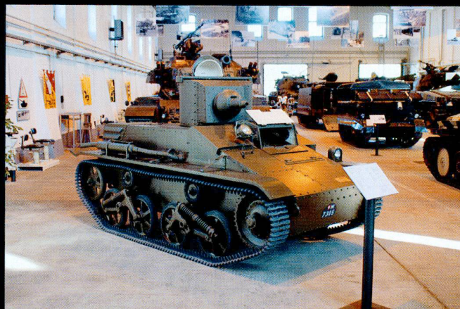
Au début des années 1930, 6 chars légers Vickers armés d'une mitrailleuse modèle 1911 sont mis en service.
