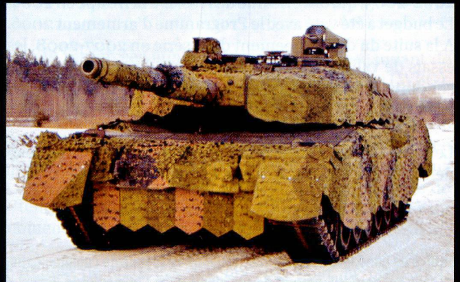
Comme d'autres véhicules, le Léo peut être équipé d'un kit de camouflage Barracuda multi-spectral.
