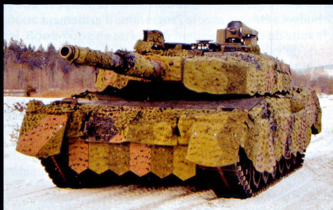
Comme d'autres véhicules, le Léo peut être équipé d'un kit de camouflage Barracuda multi-spectral.
