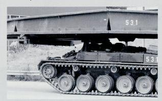
Le char poseur de ponts 68/88 permet les franchissements jusqu'à 18 mètres d'engins jusqu'à 60 tonnes.
