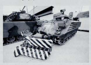
Le char de déminage léger est en mesure de dégager des routes ou des sols durs sur une largeur de 4 mètres.
