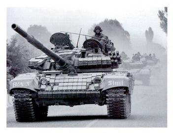
Les troupes engagées par Moscou étaient pour la plupart de second échelon, équipées comme ici avec du matériel daté. Ici, des chars T-72M2 équipés de surblindages réactifs, afin de les protéger contre les armes antichars portables à charge creuse.
