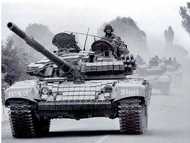
**Les troupes engagées par Moscou étaient pour la plupart de second échelon, équipées comme ici avec du matériel daté. Ici, des chars T-72M2 équipés de surblindages réactifs, afin de les protéger contre les armes antichars portables à charge creuse.**
