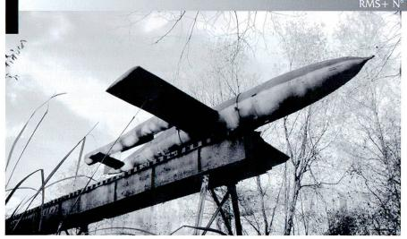
L'arme de représailles (Vergeltungswaffe) V1, développée à partir d'un avion à réaction à l'origine destiné à être piloté (Fi 103), devient en 1944 une fusée sans pilote lancée/mis en azimut à partir de rails fixes ou escamotables. La portée dépend de la quantité de carburant embarquée et des conditions météorologiques.
