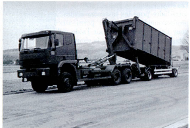
Le système de chargement interchangeable WABRA/WELASYS.
