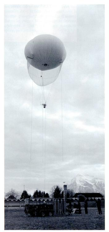
L'utilisation de ballons captifs chargés de caméras permet l'observation jusqu'à des distances pouvant aller jusqu'à 65 km.
