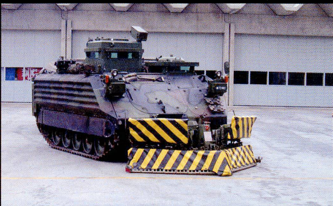
Le char de déminage léger 00 est en mesure d'ouvrir, de déblayer et de faire détonner des mines sur surface dure.
