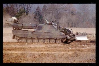
Le char du génie permet d'ouvrir des brèches en terrain meuble. Il est équipé d'une lame, d'un bras articulé et peut recevoir un système de déminage lourd.
