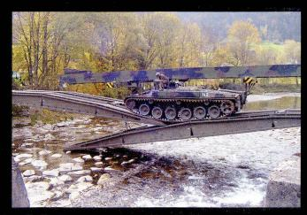
Le char poseur de pont 68/88 permet de franchir des coupures jusqu'à 18 mètres. Armeefilmdienst.
