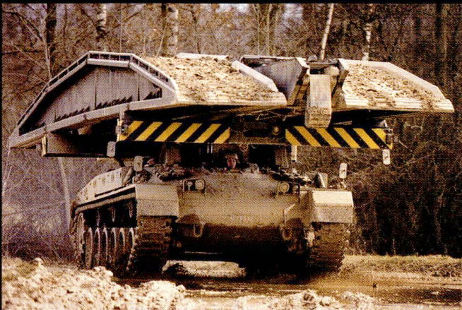
Le char poseur de pont 68/88 permet de franchir des coupures jusqu'à 18 mètres. Armeefilmdienst.
