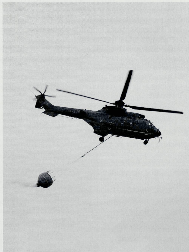
Le Super Puma peut être porter jusqu'à 4 tonnes de charges extérieures : ici, un conteneur à eau est utilisé pour la lutte contre les incendies.
