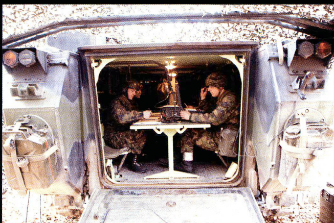
Les postes centraux de tir sont équipés du calculateur FARGO et du système intégré de conduite INTAFF.
