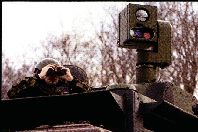
Le Eagle possède des instruments d'observation et de conduite des feux.
