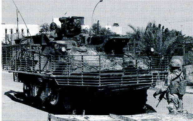
Véhicule de combat Stryker en Irak, avec sa «cage», censée faire exploser prématurément les projectiles à charges creuses.
