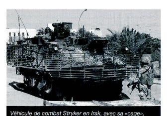
prématurément les projectiles à charges creuses avant qu'ils n'atteignent le blindage proprement dit. L'alourdissement de plusieurs tonnes et l'augmentation de l'encombrement dus à la grille métallique ont cependant pour conséquence une diminution de la mobilité du véhicule.
