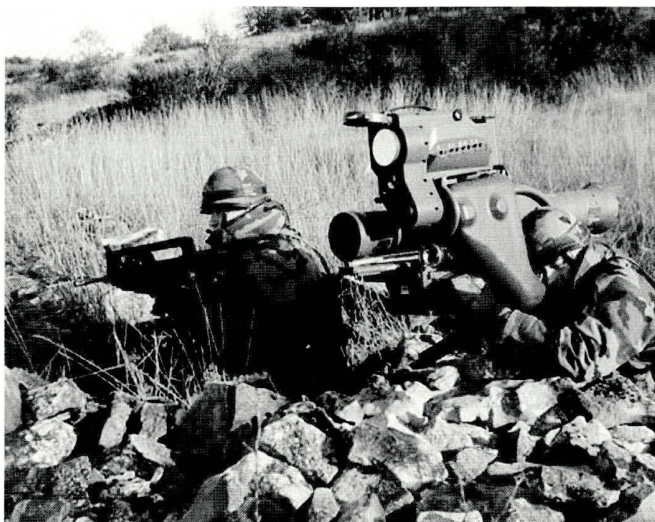
Les premières versions du Milan européen étaient encombrantes, notamment en raison de l'ajout d'un système de vision thermique. Mais il est efficace de 200 à 2000 mètres.
