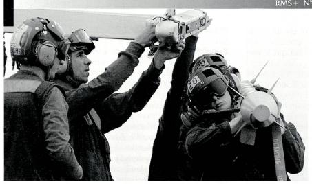
Simple, bon marché et performant: le Sidewinder est un système d'arme à contrecourant. Adapté d'une simple roquette non guidée, il est maniable et peut être transporté/ monté à la main, à l'instar de cet AIM-9P (gauche).
