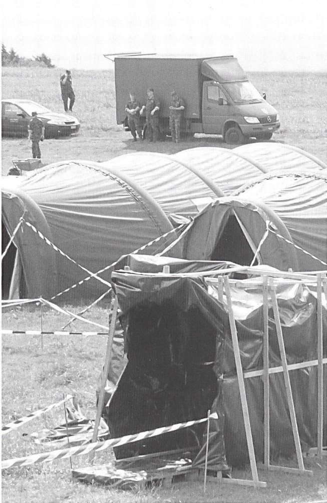
3 Sas d'entrée/sortie de la zone contaminée avec, à l'avant, un passage de décontamination avec douche.
