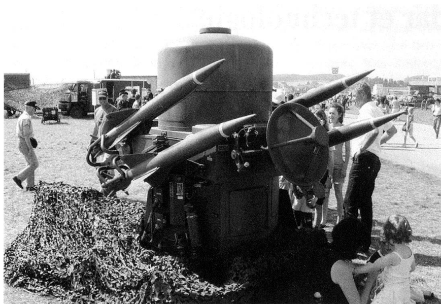
Le système Rapier combine 3 radars (surveillance, poursuite, guidage).
