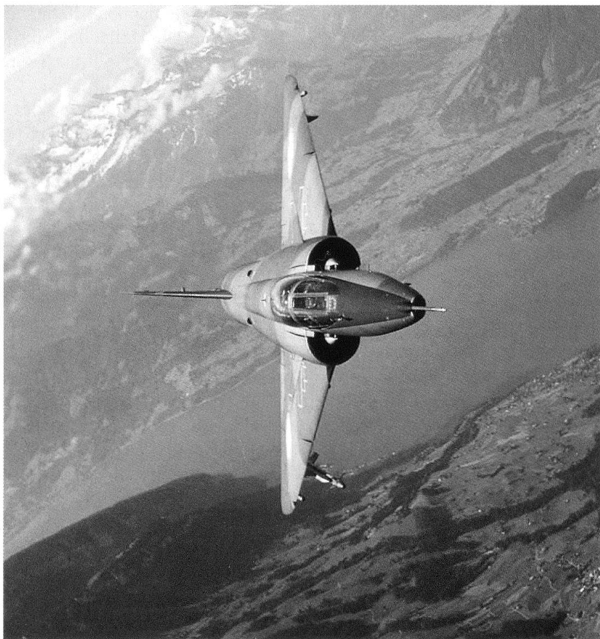
Le Mirage III RS n'est pas équipé de radars, mais il conserve l'armement du chasseur.
