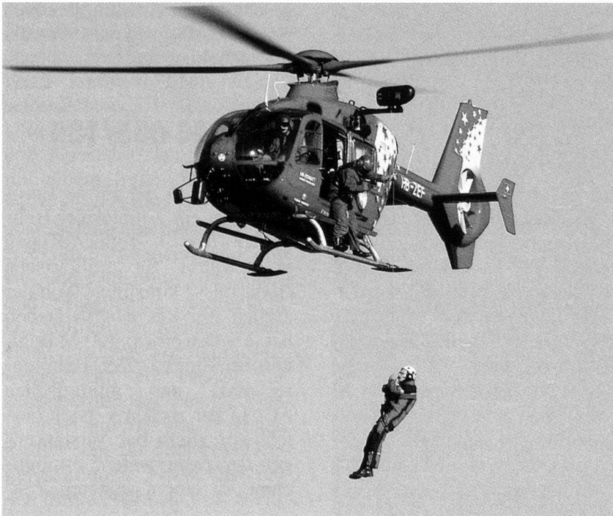
Der EC635/135 ist mit einer sehr bedienerfreundlichen Rettungswinde mit 50 m Seillänge ausrüstbar.
