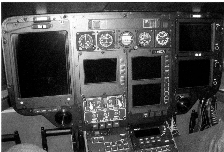
Das moderne Glascockpit des EC635/135 weist viele Analogien zum TH 98 Cougar auf.
