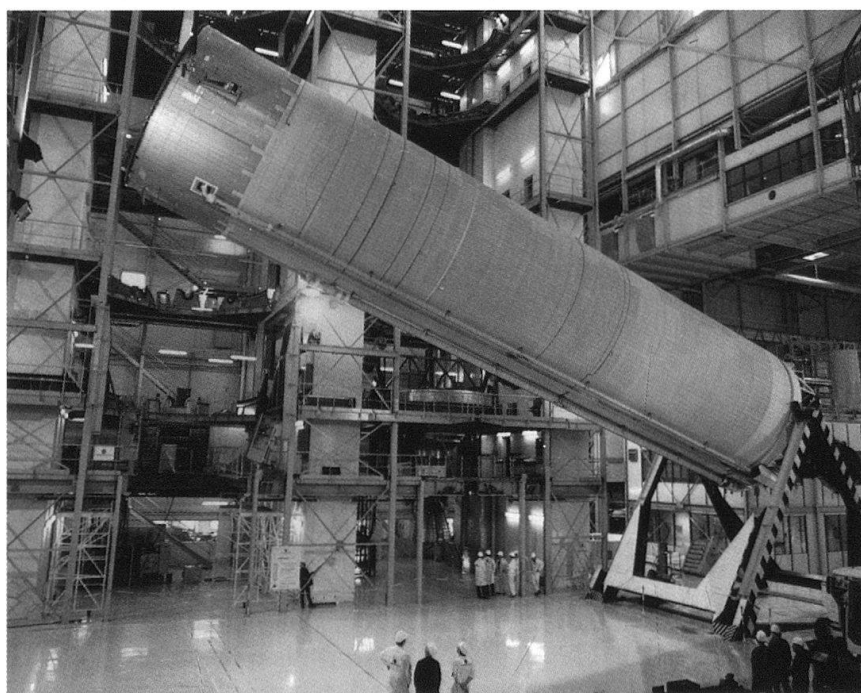
Etage principal d'Ariane-5 mis en conteneur pour expédition au Centre spatial guyanais. (Photo: Aérospatiale)
