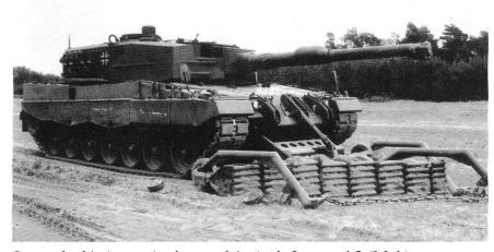
Lame de déminage Amir sur châssis du Leopard 2 (Mak).
