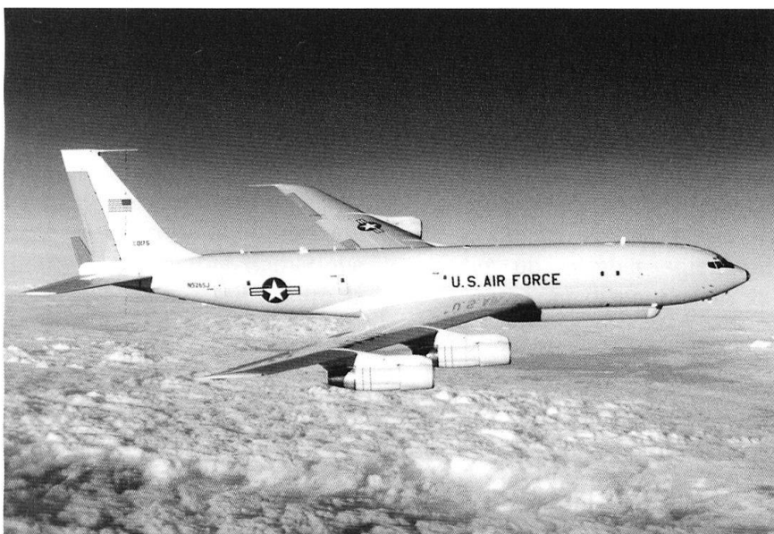
Fixé sur le ventre de l'avion, un Joint Surveillance Target Attack System (Joint STARS).
