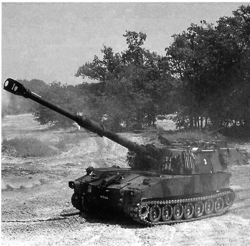
L'obusier M-109 KAWEST, doté d'un système de navigation et d'un ordinateur, dispose d'une portée et d'une autonomie en munitions accrues.
