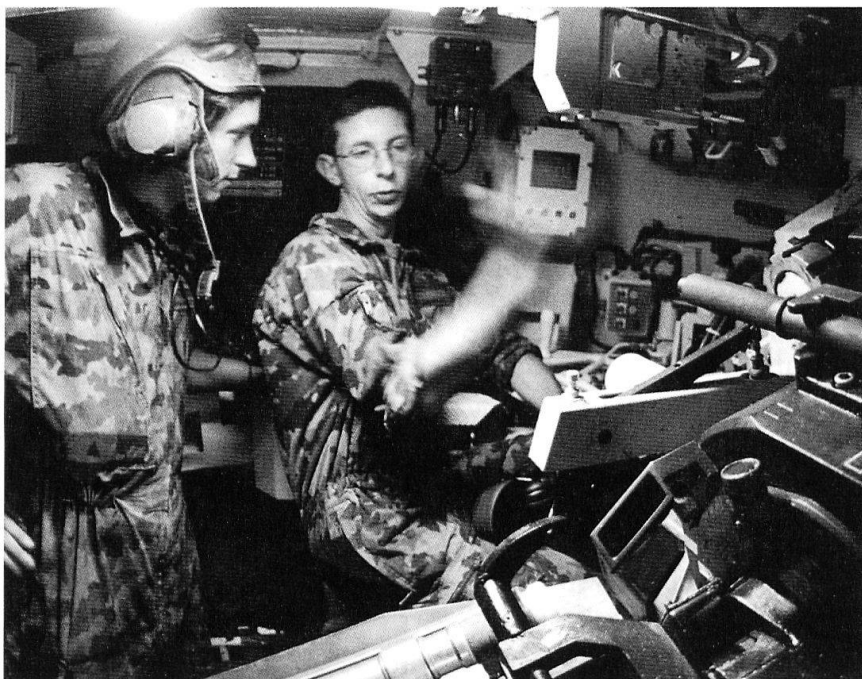
L'obusier M-109 KAWEST, doté d'un système de navigation et d'un ordinateur, dispose d'une portée et d'une autonomie en munitions accrues.
