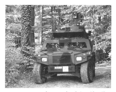
Les commandants de tir ont échangé leurs M-113 pour un véhicule rapide, discret et bien protégé. L'optronique et les systèmes de transmission de données du Eagle en font une pièce importante sur le champ de bataille numérique.
