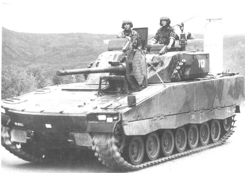
La version de série du CV-9030 suisse dispose d'une rampe arrière, de blindages additionnels, d'un châssis réhaussé, d'aménagements intérieurs sur mesure, et d'un bus de données couplé à un Battlefield Management System (BMS).
