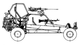
Light Strike Vehicle (LSV) des Forces Spéciales US durant la guerre du Golfe. Le LSV est un véhicule de reconnaissance hautement mobile permettant un concept dynamique du renseignement tactique/opératif. Il comprend 3 hommes d'équipage et évolue à une vitesse proche de 100 km/h. Sa structure tubulaire lui confère une signature radar très faible. [Dessin J. Baud]
