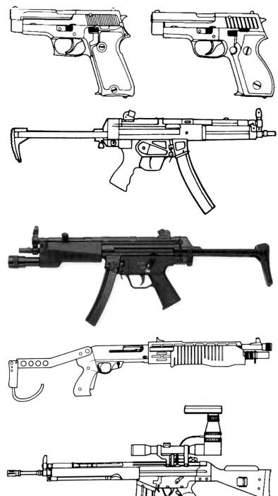
Franchi SPAS 12 – Un fusil à pompe à répétition manuelle et semiautomatique, conçu pour les FS italiennes. Le crochet sous la crosse peut pivoter et permettre ainsi le tir d'une seule main. [Dessin J. Baud]
