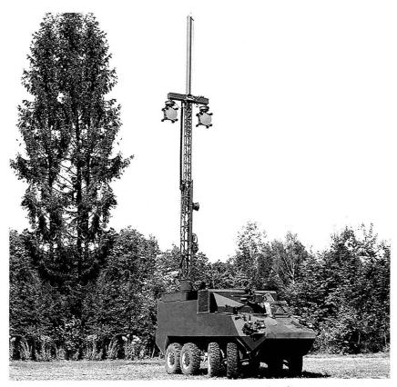
Char RAP avec mât intégré et antennes montées fixes.
