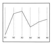
Notez les 6 axes parallèles et espacés également étiquetés X1 à X6. Les point (x1,..xn) sont tracés en repérant la coordonnée xi le long du ième axe. La ligne, représentant le point de l'espace à six dimensions, connecte tous les points.
