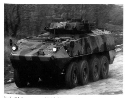
Piranha III 8x8 avec canon stabilisé de 25 mm.
